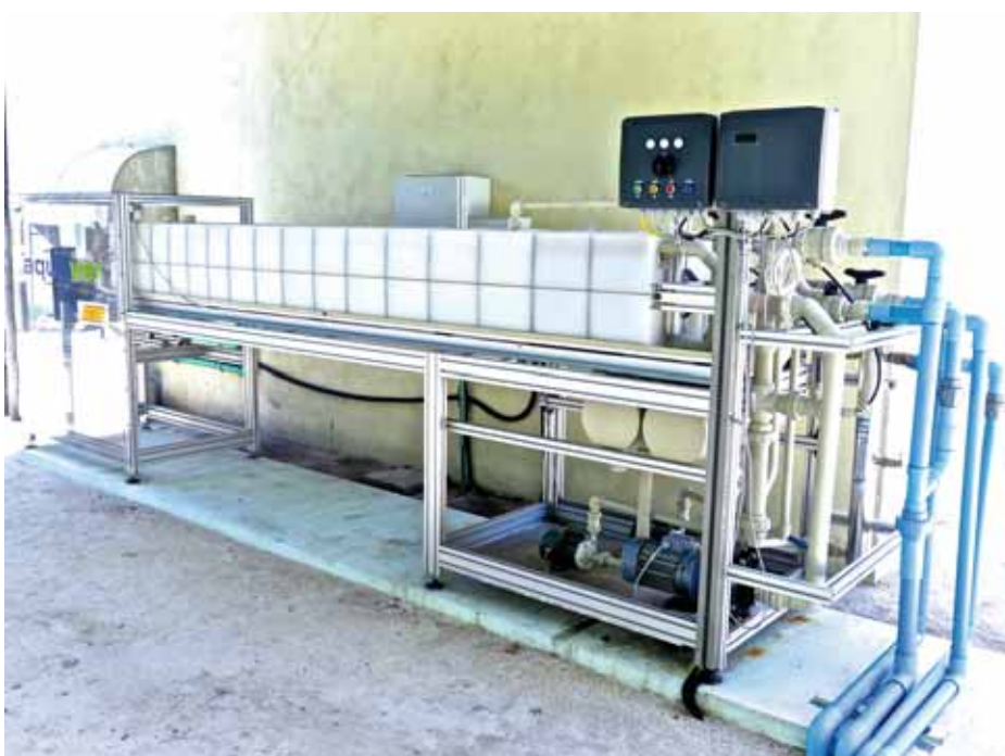
◀ Abbildung 3 Vakuüm-Multi-Effekt-Membrandestillations-Anlage „MDS500“ von memsys B.V. (ehemals Aquaver B.V.) zur Meerwassersalzung auf Gulhi (Malediven).
